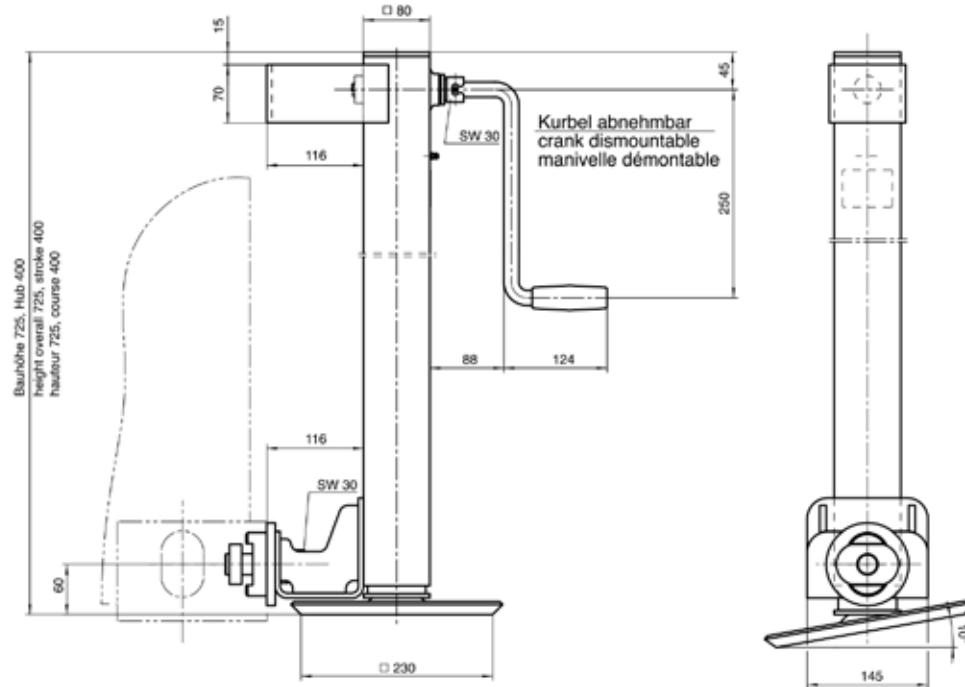
**Die Nivellierstützen werden an den ISO-Ecken des Containers angeschlagen und verriegelt. Anschließend kann der Container durch Drehen an den Kurbeln angehoben und ausnivelliert werden.**
